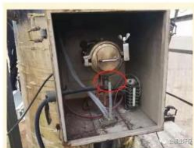
采样探头过滤器，探杆管路堵塞
