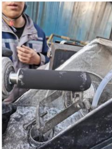
采样探头过滤器，探杆管路堵塞
