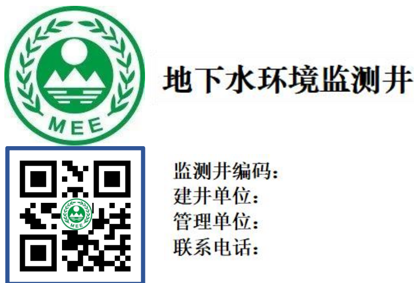
图 D.1 监测井配套二维码的铭牌示意图
